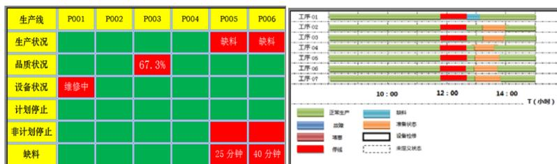
以进度条的方式对生产线每工序状态进行监控，对各生产线的生产状况、设备状况、品质状况进行即时的监控；
