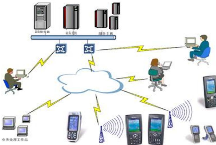
对于大型的仓库，由于仓库作业无法在计算机旁直接作业，可以使用手持数据终端先分散采集相关数据，后把采集的数据上载到计算机系统集中批量处理。此时给生产现场作业人员配备带有条码扫描功能的手持数据终端，进行现场的数据采集。同时在现场也可查询相关信息，在此之前会将系统中的有关数据下载到手持终端中。
