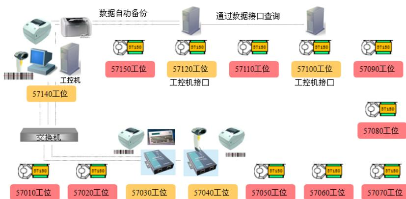
精诚 EAS-MES 生产制造执行系统基于大量的网络硬件设备和条码扫描设备，这些设备的正常运行保证了系统的稳定，是生产车间管理系统安全、高效、稳定运行的前提，包括：
